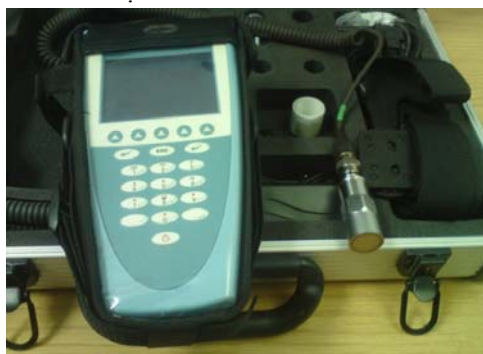
Slika 3. Aparatura sa prenosivim uređajem OneproD MVP-2EX ili MOVIPACK EX (tip= APT 1105)
